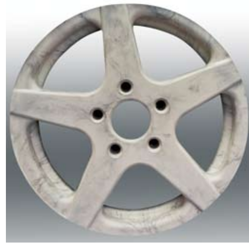
Leichtbau Rad aus faserverstärktem Kunststoff, Fraunhofer-Institut für Chemische Technologie ICT
