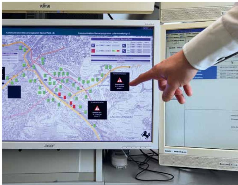
Die Grunddaten für die aktuelle Verkehrslage in Stuttgart liefern insgesamt 335 Mess-Schleifen.
